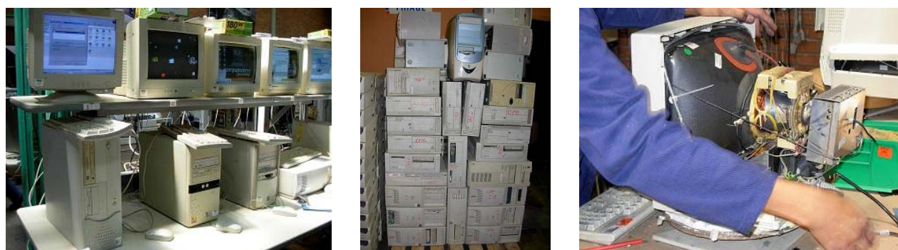
Gráfica 38: Algunas impresiones del proceso de reacondicionamiento en CPE (izquierda: testing; medio: triage de equipos donados; derecha: limpieza y reparación de un monitor).
