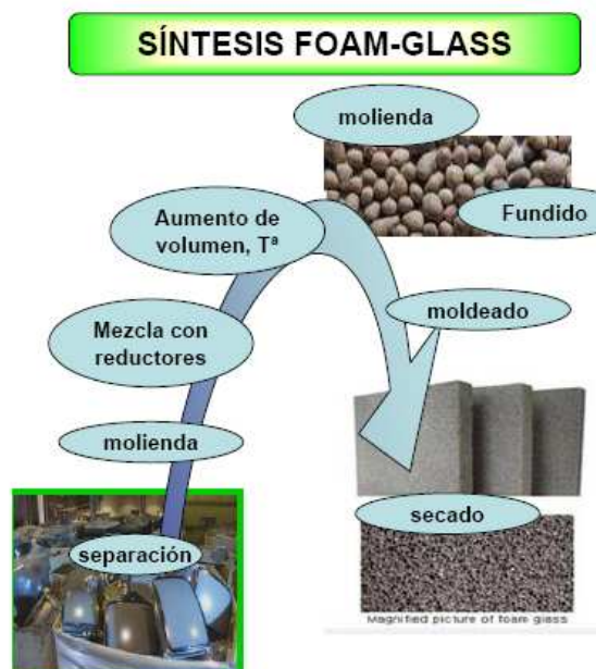
Figura 2.23 esquema fabricación foam glass (fuente Eco TV 2007)
