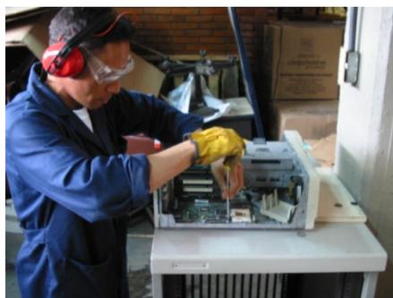
Recuperación de partes y componentes electrónicos
